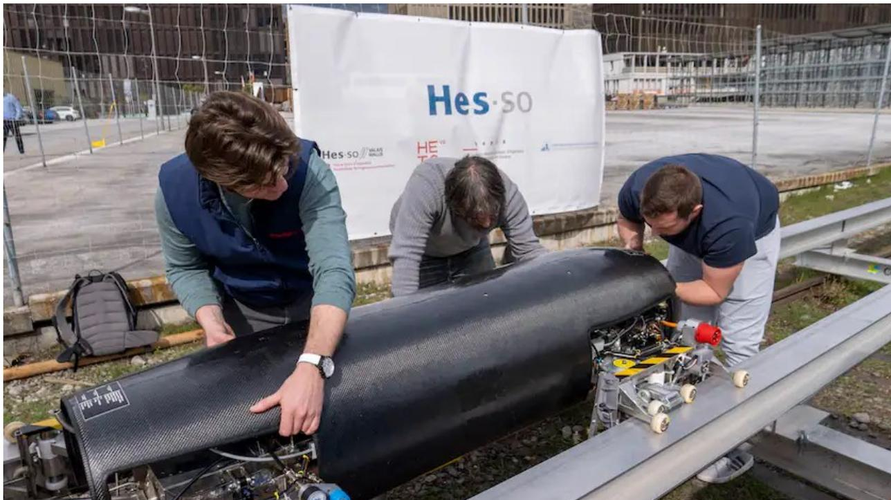
Deux démonstrateurs ont été testés à Sion: Ohwaboo (photo), un véhicule à sustentation magnétique passive atteignant 130 km/h en une seconde, et MoLinHo, propulsé par un moteur linéaire homopolaire – une première en Suisse.
