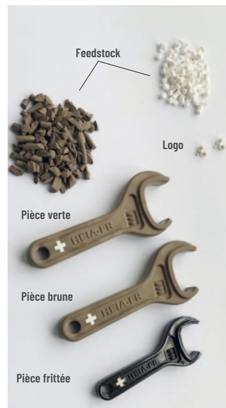
Fig. 4 : Les quatre étapes de base du processus CIM: préparation des matières premières, moulage par injection (pièce verte), délianté (pièce brune) et frittage (pièce frittée). Par ailleurs, la pièce intègre un logo par surmoulage.
