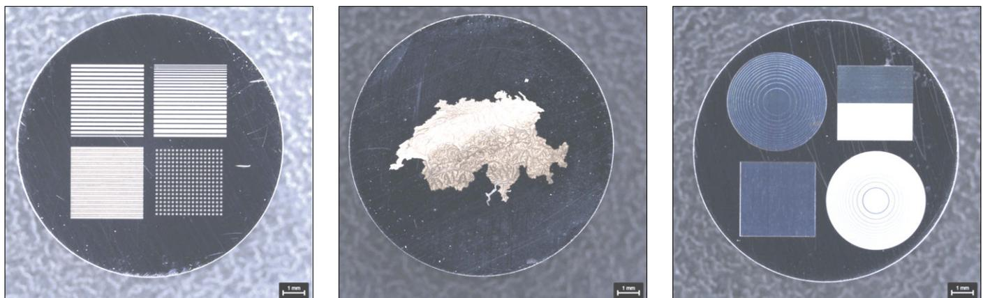
Bild 2: Hergestellte Mikrostrukturen – Periodische Strukturen (links), Topographische Karte der Schweiz (Mitte), Technische Strukturen (rechts) wie Fresnel Linsen und diffraktive optische Elemente. (Quelle: iRAP/ALPS)
