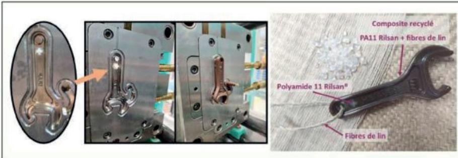
Fig. 3: Production de pièce en composite biosourcé recyclé par injection avec surmoulage
