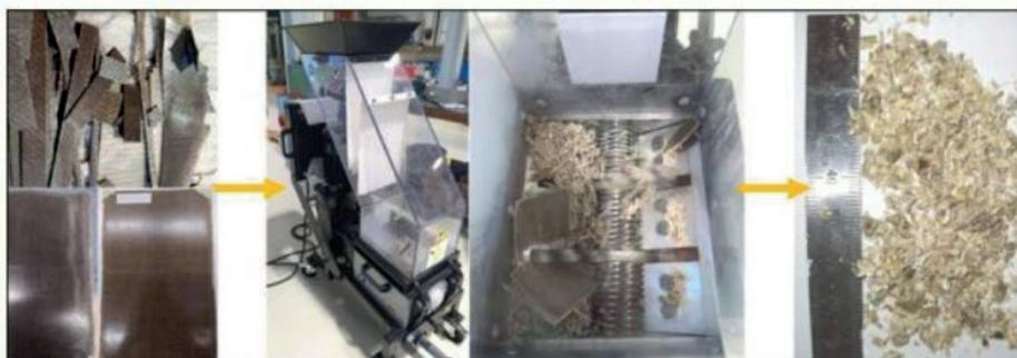
Fig. 1: Concassage de plaques composites biosourcées (images: Institut iRAP)
