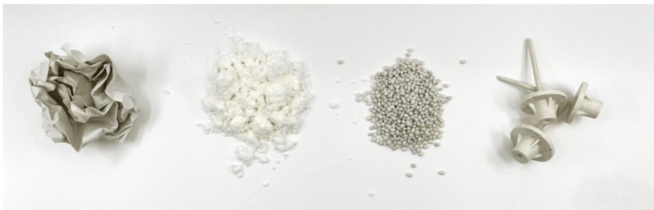
Vom Papier über Pulp und Granulat zum Spritzgussbauteil (Bilder: IWK)
