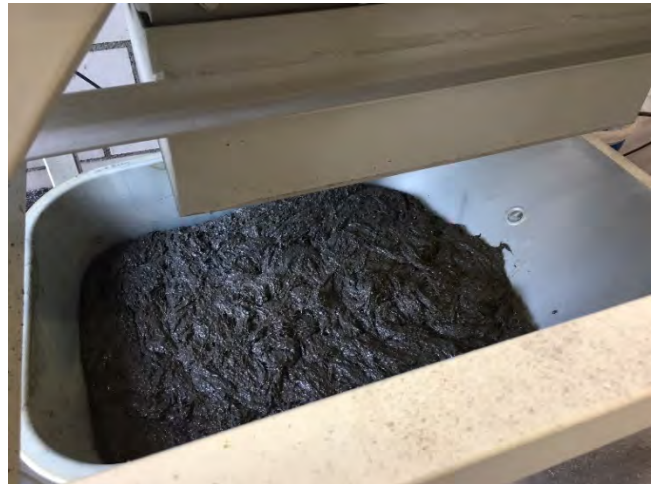
Abbildung 10: Frisch-UHFB mit zäher Konsistenz
