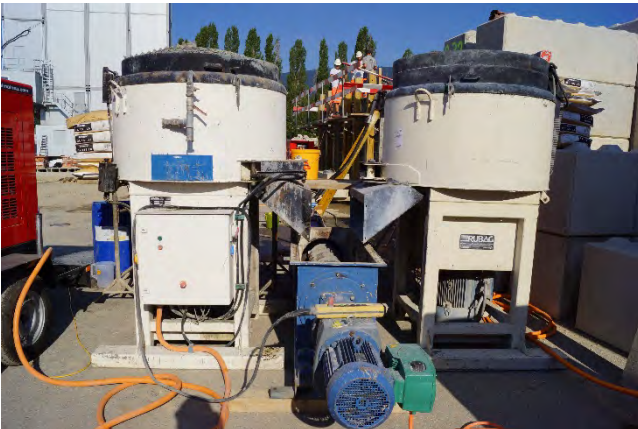
Fig. 17 : Malaxeurs à béton
