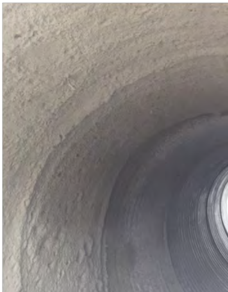
Figure 7 : Essais de convenance : état de surface après la projection
