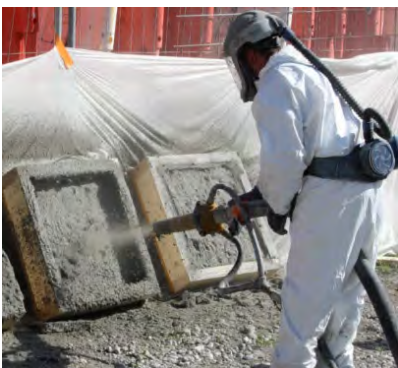
Figure 3 : Confection des caisses par projection et essais en compression
