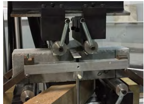
Figure 4 : Essais de flexion sur prismes au laboratoire de l'IFSTTAR
