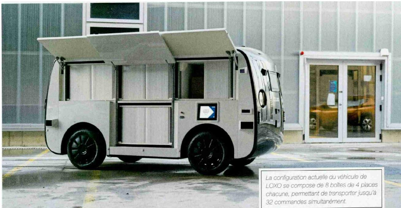
*La configuration actuelle du véhicule de LOXO se compose de 8 boîtes de 4 places chacune, permettant de transporter jusqu'à 32 commandes simultanément.*
