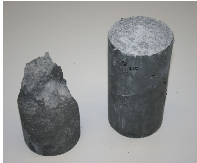
Figure 3 : Loi de comportement en compression à l'ELU du BFUP selon [8] et comparaison à la rupture de cylindres sans (à gauche) et avec fibres (à droite).
