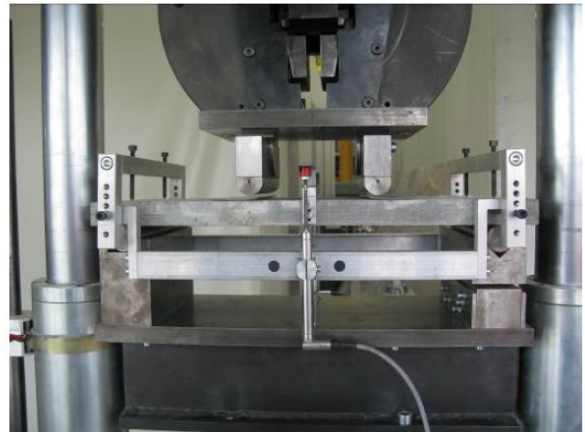
Figur C1 Biegeversuch an Plattenförmigen Probekörpern aus UHFB, Abmessungen in mm.
