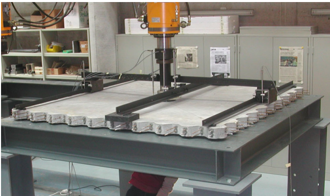
Abbildung 1.2. Durchstanzversuche an dünnen Platten aus Hochleistungs-Faserbeton
