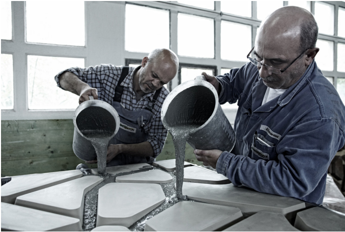
Fig. 16: Giessen von Fassadenelement Vena
