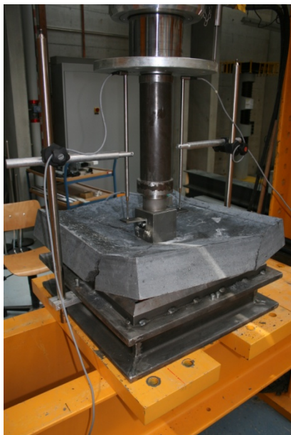
Abbildung 2.8. Plattenversuch gemäss SIA 162/6 [11]
