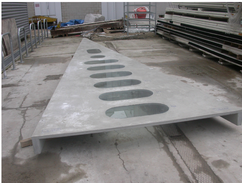
Figure 27 : Élément d'essai - couverture du stade Jean-Bouin.
