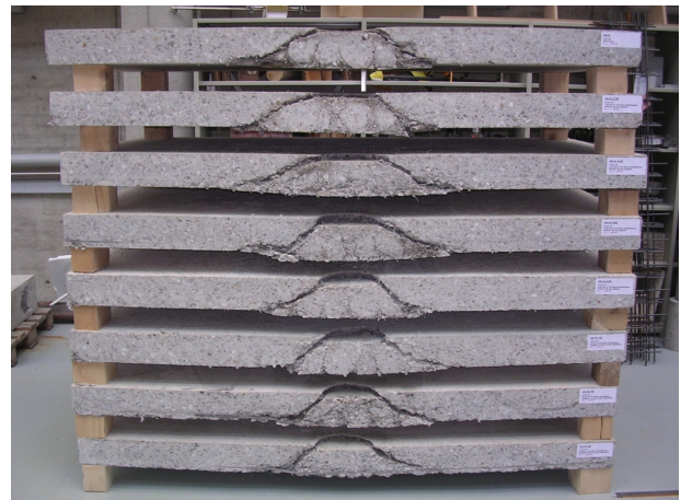
Abbildung 1.4. Durchstanzversuche an Platten
