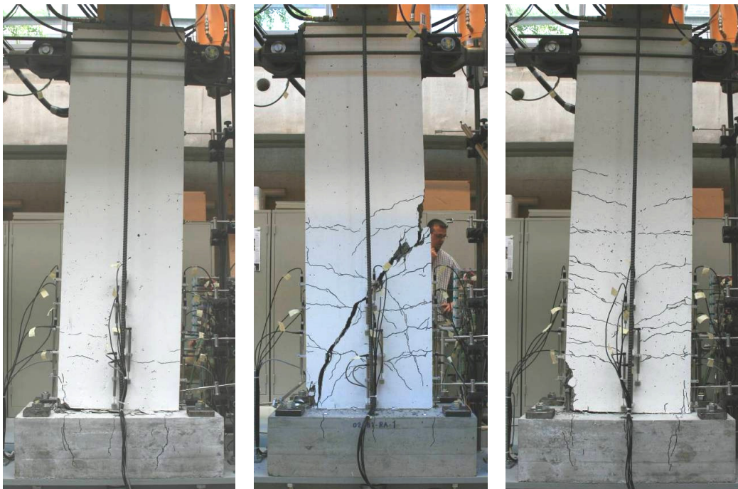
Abbildung 1.6. Statisch-zyklische Belastungsversuche an Wänden aus HLB und UHFB
