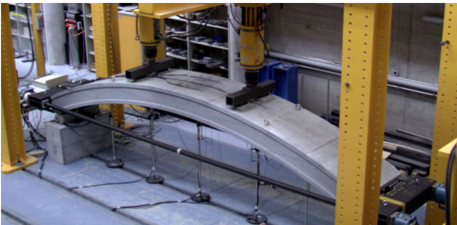
Abbildung 1.1. Belastungsversuche an Tunneltübbingungen aus Hochleistungs-Faserbeton
