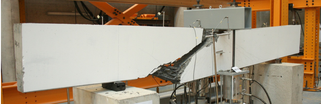
Abbildung 1.5. Biege- und Schubversuche an Balken
