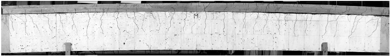
Abb. 8: Verbundbalken mit gerippter UHFB-Bewehrung bei 90% seiner Traglast.
