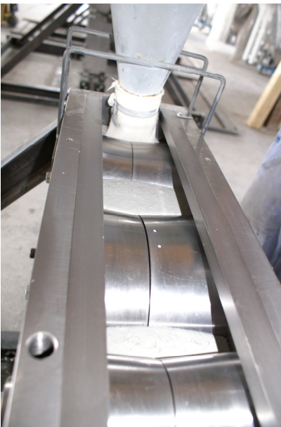
Fig. 12: Stahlschalung Fassadenelement DYB
