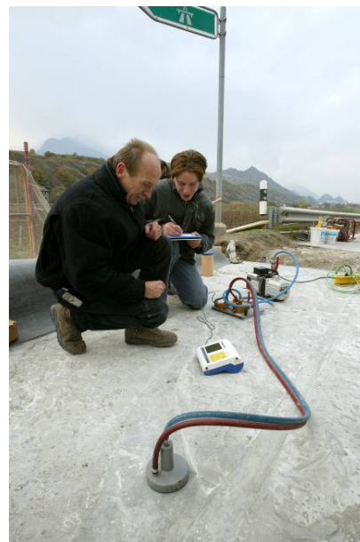
Fig. 5 a) Perméabilité à l'air kT pour des bétons et un BFUP, b) essai de perméabilité à l'air selon Torrent, sur ouvrage.
