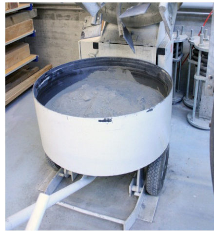
Abbildung 2.2. Zwangsmischer Typ mit Zyklus
