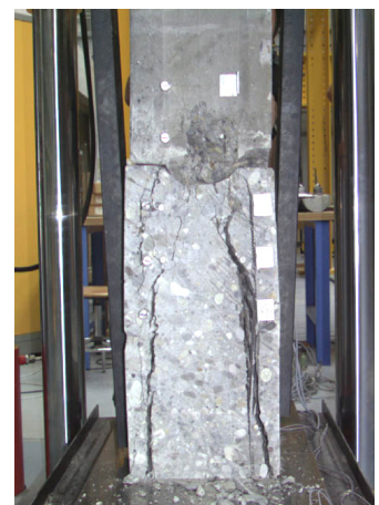
Abbildung 1.1. Belastungsversuche an Tunneltübbingungen aus Hochleistungs-Faserbeton
