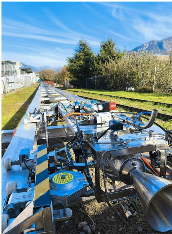
Véhicule expérimental à sustentation magnétique passive, Ohwaboo est capable d'atteindre une vitesse de 130 km/h en une seconde. HES-SO
