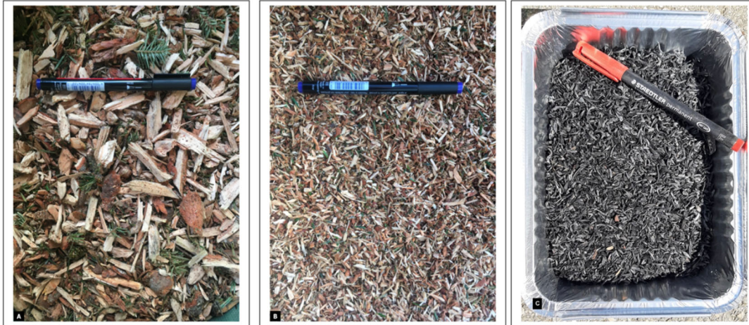
Figure 1. Résidus de branches d'épicéa brutes (A), coupées et tamisées (B), et transformées en biochar activé (C).
