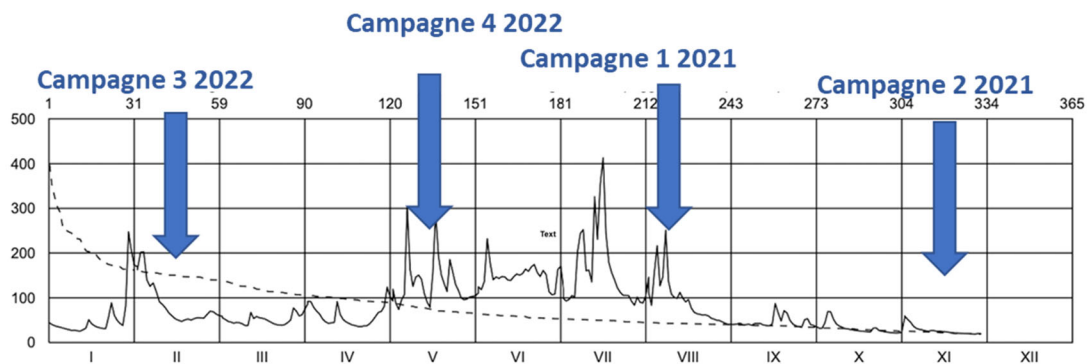
Figure 7. Hydrogramme des moyennes journalières (ligne continue) et courbe des valeurs classées moyennes journalières (ligne traitillée) en m^3/s pour la station de réinfiltration de l'Arve – Bout du Monde, pour l'année 2021. Graphique tiré de www.bafu.admin.ch
