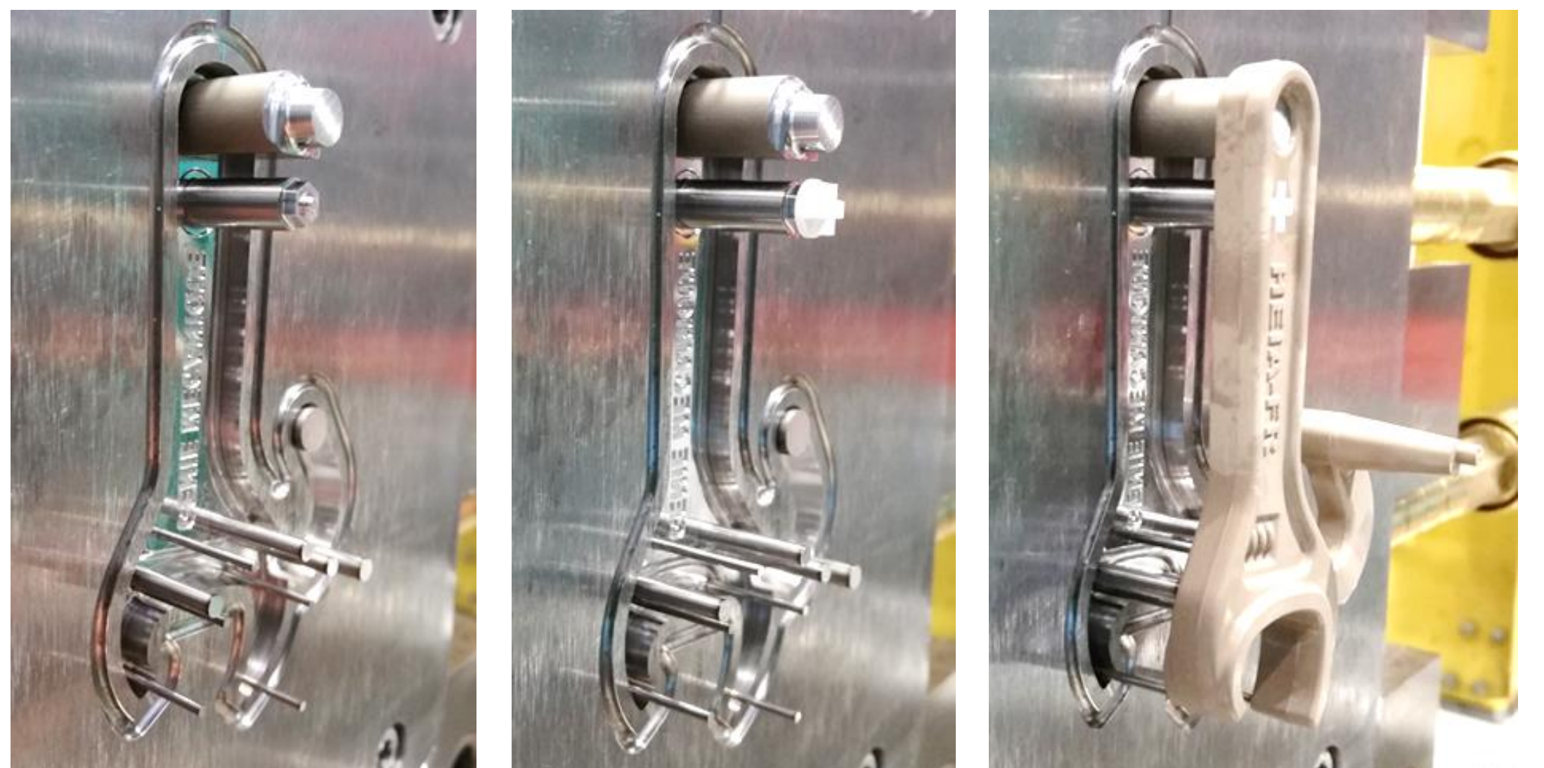
Réalisation du surmoulage CIM sur une machine d'injection.
