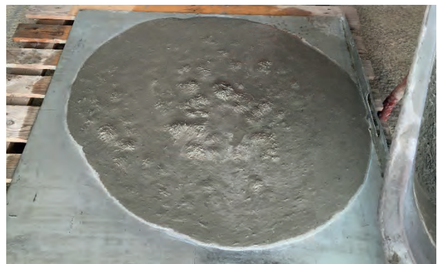
Abb. 8: Konsistenzprüfung der optimierten Mischung, welche gut eingebracht werden konnte aber immer noch Faserklumpen aufwies
