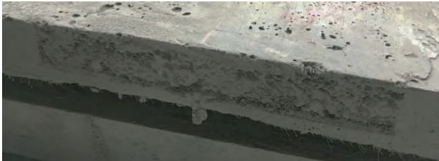
Abb. 26: Querschnitt durch 1. Muster- Elementfuge mit schlechtem Verquuss
