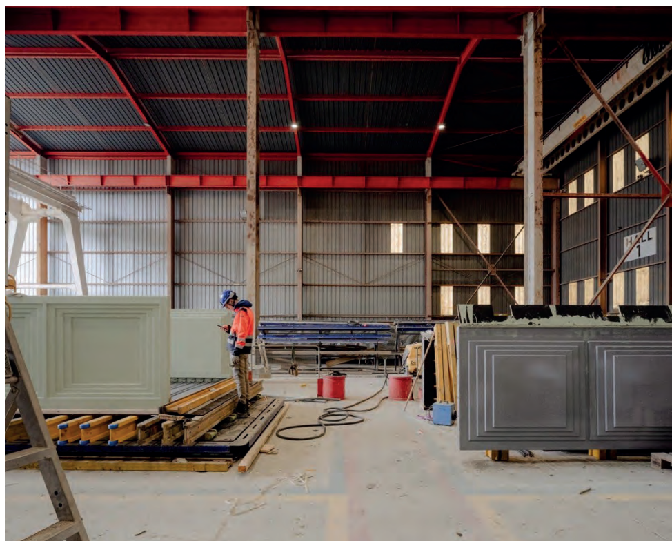
Fig. 6 : Photographie de l'usine de préfabrication – poutres latérales (gauche) et coffrages en négatifs (droite) @ François Baudry
