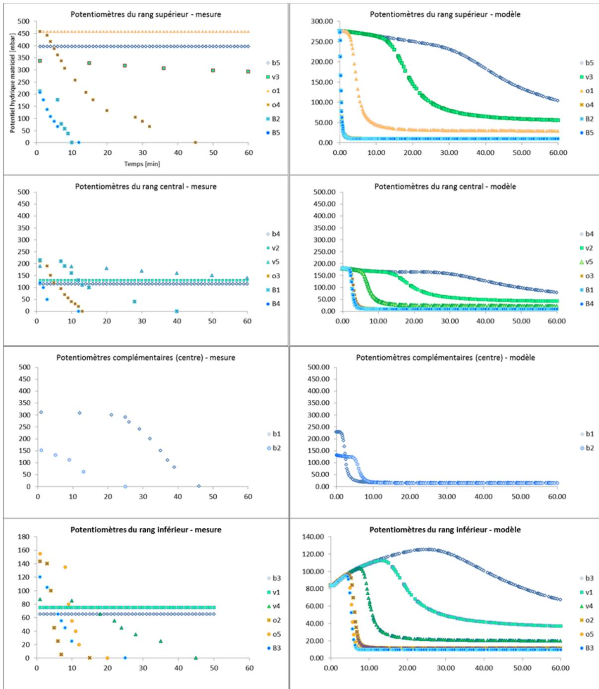
Figure 16 : Débit 0.05 l/s sur cassette BC30%, en présence du canal de répartition de flux
