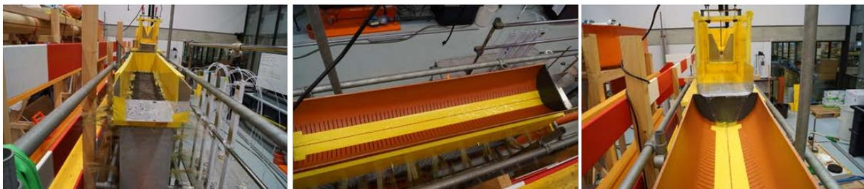
Figure 7 : cassette montée sur le banc sans le canal de distribution et avec le canal mis en place
