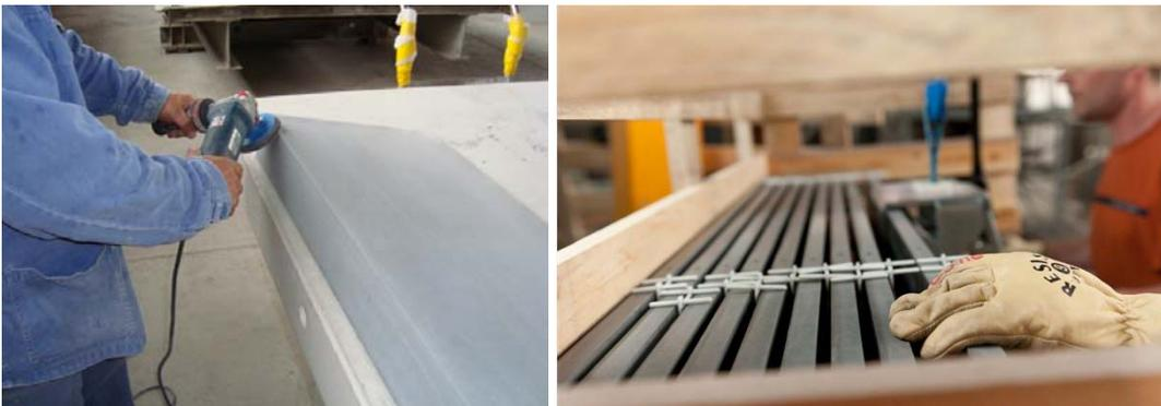
Fig. 5 (gauche) et 6 (droite) : Les arêtes sont ebarbées et les éléments sont stockés et transportés à la verticale.
