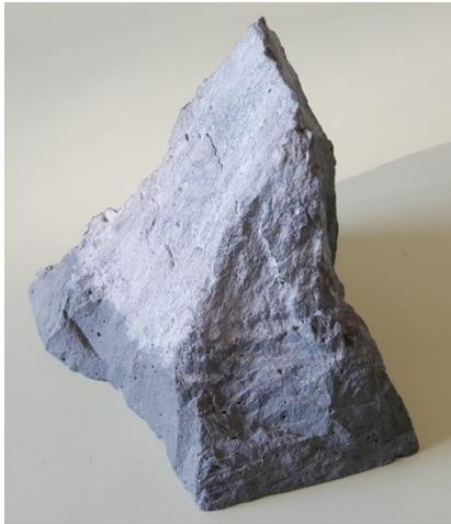
Reste d'une éprouvette cubique ( $a = 150 \text{ mm}$ ) non fibrée (matrice seule) après un essai de compression. La rupture s'est produite de façon explosive sous une contrainte de  $130 \text{ N/mm}^2$  (photo Holcim).
