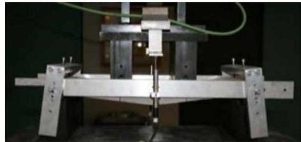
Fig. 8 Dispositif d'essai de flexion 4 points
