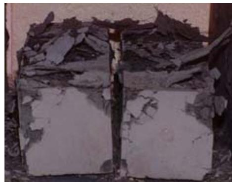
Écaillage des éprouvettes soumises à une température de 500°C
