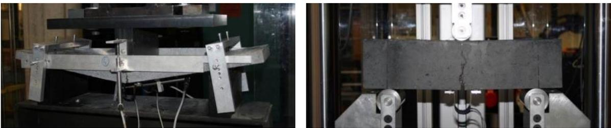
Fig. 4 Essais de flexion pour la caractérisation du BFUP en traction
