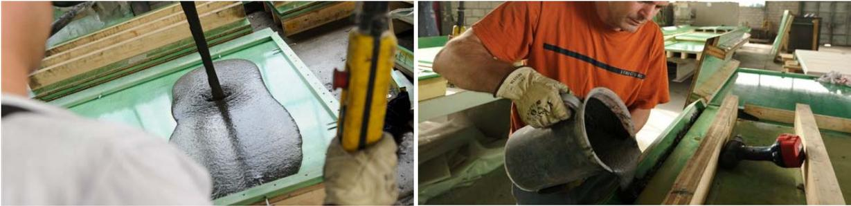
Fig. 3 (gauche) et Fig 4 (droite) : Mise en place du béton dans des moules en bois laqué.
