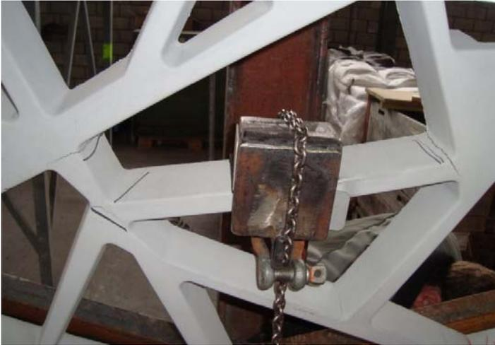
Fig. 12 : Flon Pépinières, Lausanne (Suisse) droite : élément fissuré sous charge de 300 kg
