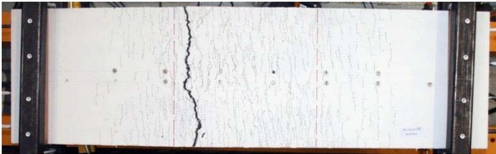
Fig. 11 Faciès de fissuration à la rupture d'une bande de dalle en BFUP avec des armatures
