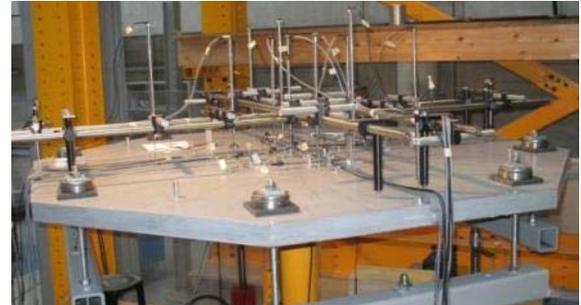
Fig. 15 Configuration des essais de flexion des dalles
