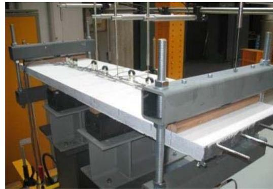
Fig. 9 Configuration des essais de flexion sur les bandes de dalle
