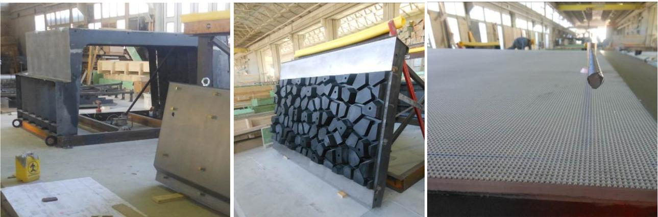
Fig. 7 Gauche : moule, Centre : matrice âme « organique », Droite : matrice surface de marche
