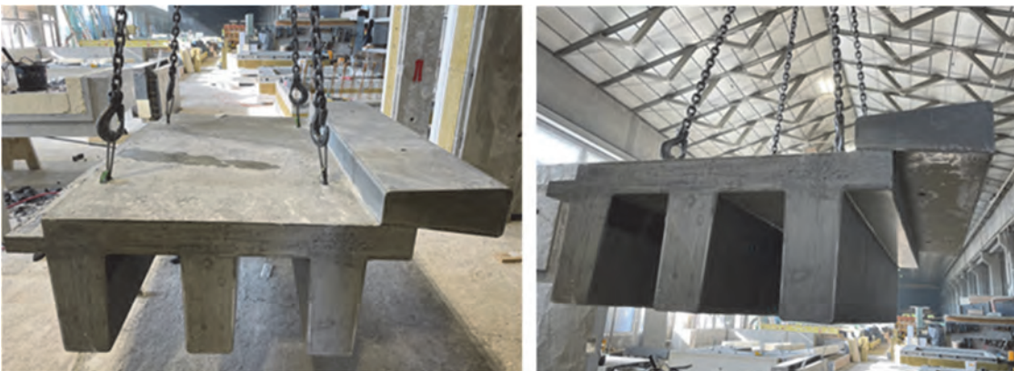
Fig. 7 : Élément de tronçon de poutre testé
