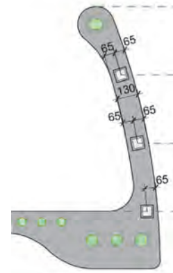
Fig. 8 : Tenons et mortaises
