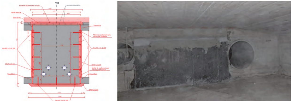
Fig. 7 : Renforcement en CFUP des entretoises : coupe transversale à gauche ; vue sur l'entretoise depuis le caisson à droite
