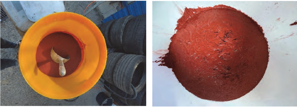
Fig. 9 : Essais de pigmentation du CFUP
