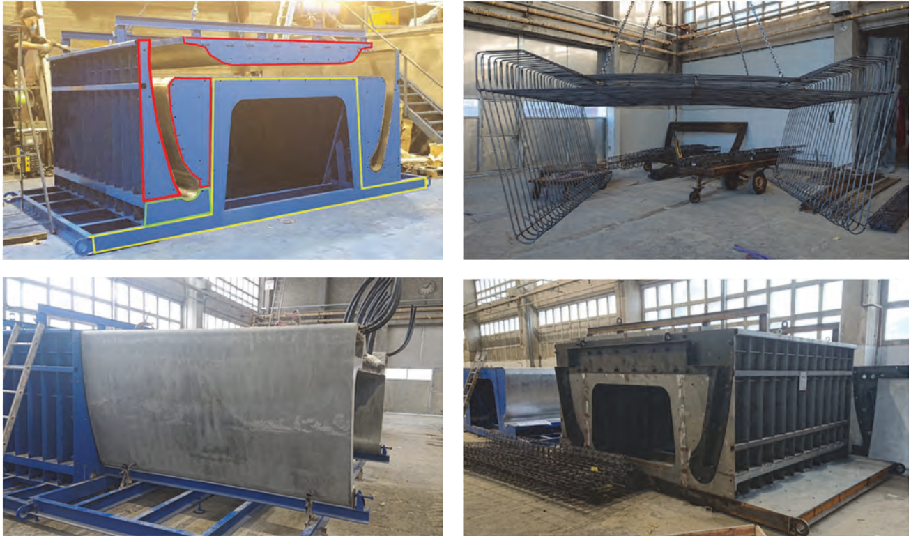
Fig. 10 : Moule métallique n°1, cage d'armature, bétonnage face contre face, moule n°2
