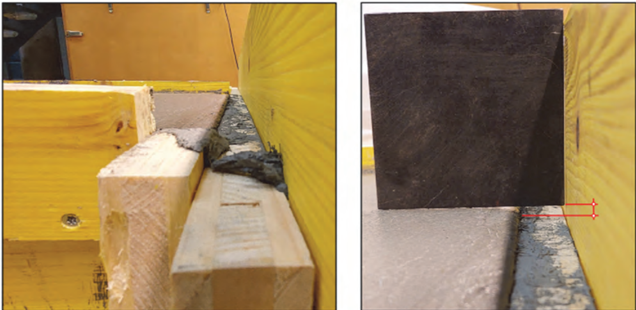
Abb. 4: Nachverflüssigung des UHFB – Test von HEIA-FR
