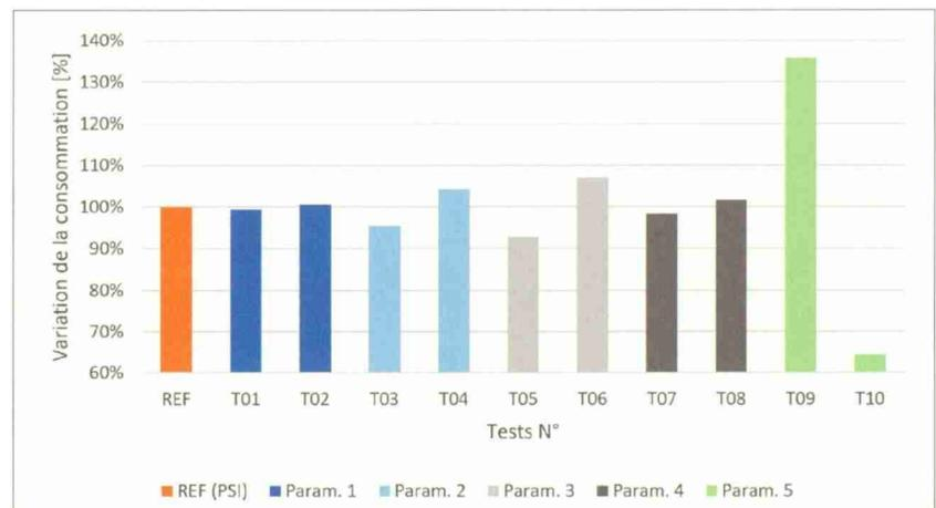
Fig. 2: Influence des paramètres d'injection sur la consommation électrique, comparé au réglage de référence «REF».
